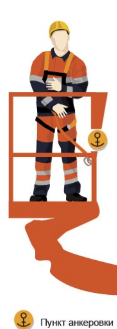
Рис. 4. Пункт анкеровки в люльке подъемника
