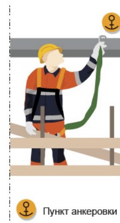
Рис. 2. Пункты анкеровки индивидуальных средств защиты, страхующих от падения с высоты
